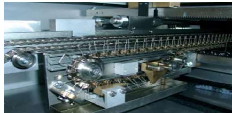
軌道鍊條輸送PCB更穩定，避免零件迴焊時因震動而造成受熱吃錫不佳狀況
