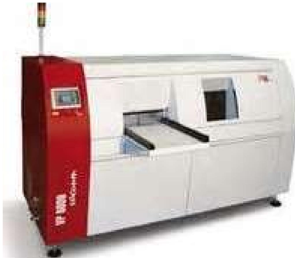
PCBA最大尺寸規格560x560(mm)
