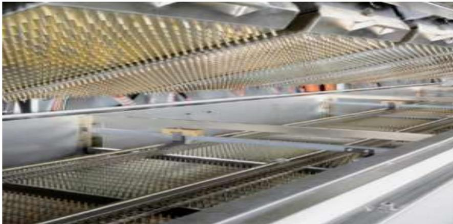
多點噴嘴，垂直風壓技術，熱傳導效果強，可提升PCB均溫性及熱補償能力
