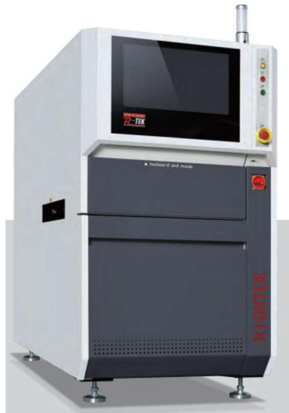
UV 鐳射打碼機可以與MES系統進行互連，自動生成二維碼內容，有效避免出現重碼，錯碼、漏碼，達到監控產品的生產過程，實現產品追溯。
