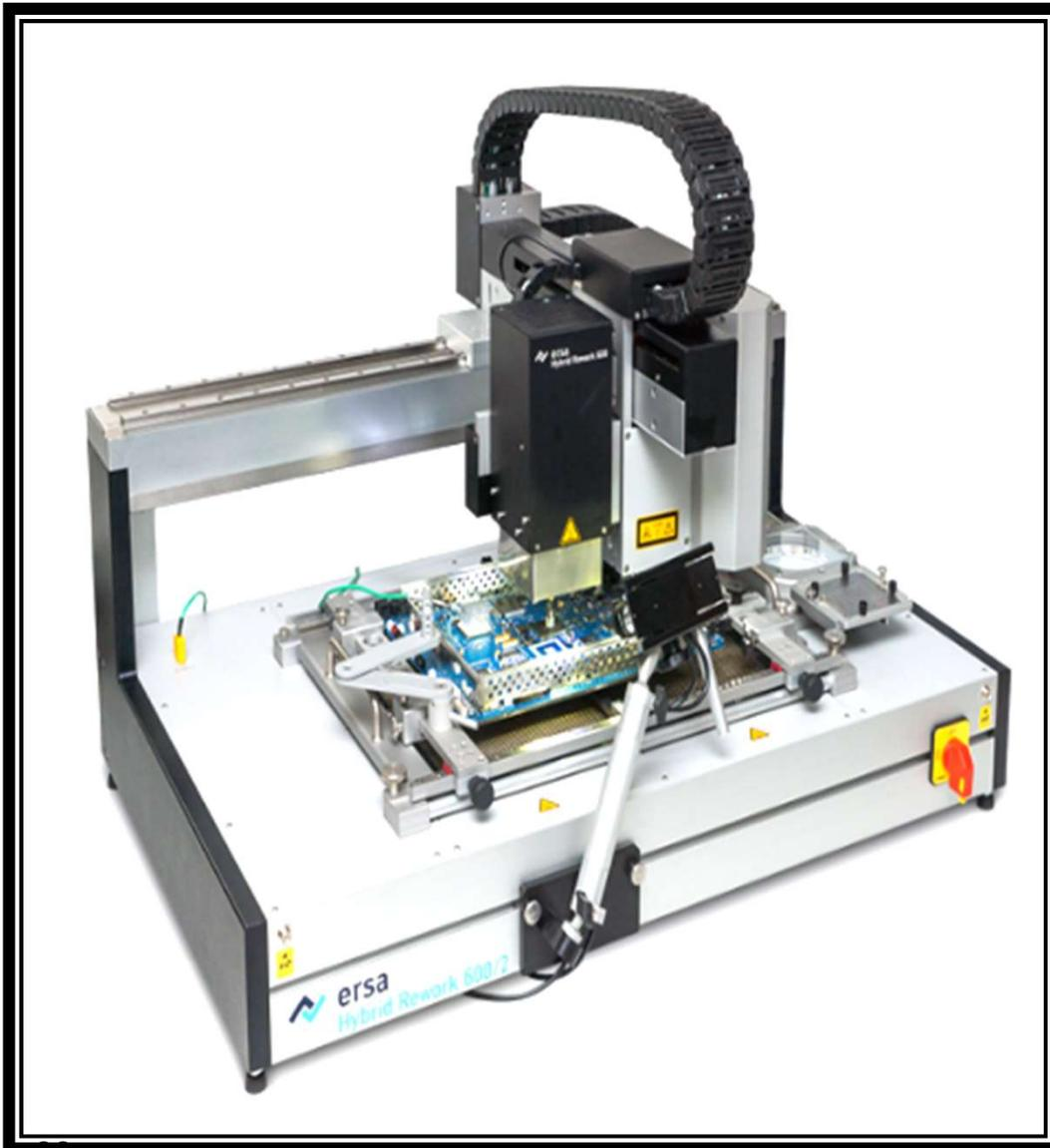
即時監測PCB板上元件溫度，有均勻和安全的加熱系統所需求的功率和靈活性，可輕易完成BGA元件的解焊、迴焊，並保護保護PCB板上加熱區域。
